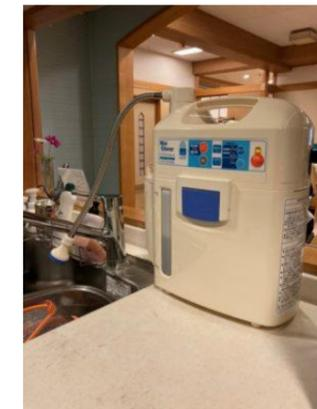
館内の除菌箇所、回数を増加させるため、一日7ℓの除菌液が精製出来る次亜塩素酸水精製器をフロアごとに設置しました。
